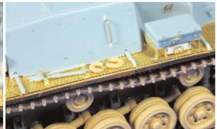
El gancho de arrastre proviene del set de herramientas para el Pz. IV de Tamiya. Observar los tornillos embutidos en el escudo lateral.
